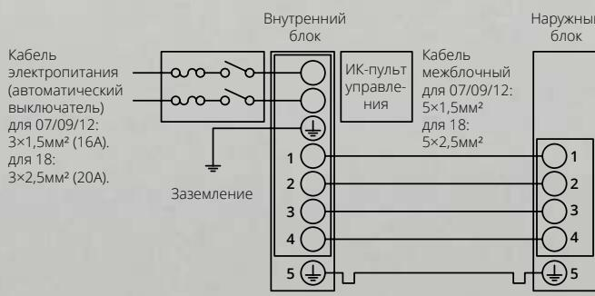
Схема подключения D On-Off (24)
