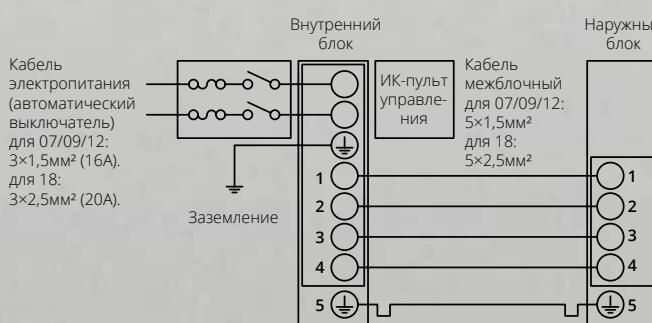
Схема подключения Smart (LK700) On-Off (24/30/36)
