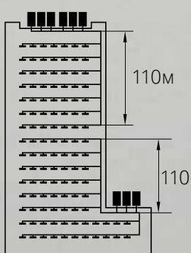
Благодаря использованию технологий полного инверторного управления и технологии переохлаждения хладагента, появляется возможность спроектировать систему с увеличенными длинами трубопроводов и перепадом высот.
