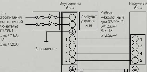
Схема подключения FJ series On-Off (24)
